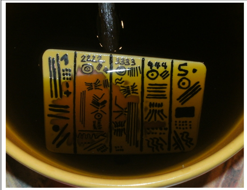
Abb. 2: Platine im Eisen-(III)-Chlorid Ätzbad
