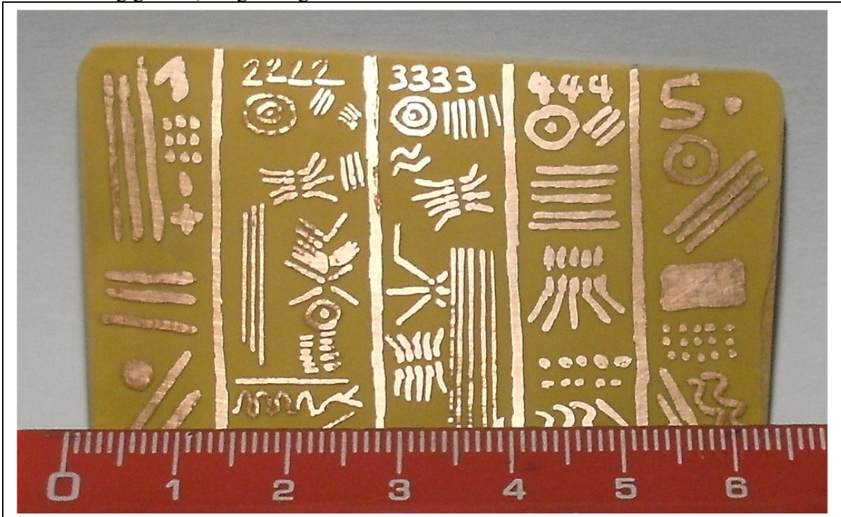
Abb. 3: Fertig geätzte, vorgereinigte Platine
